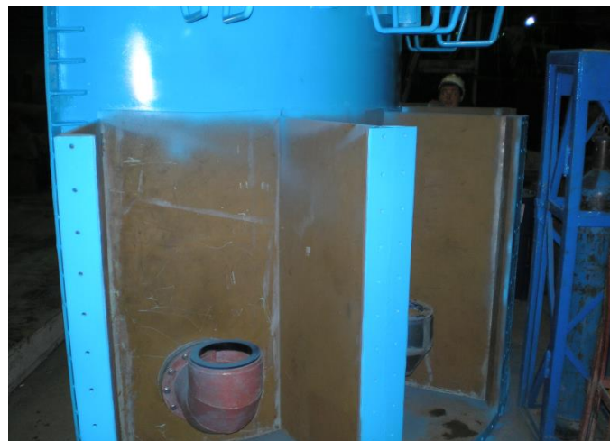
Быстросменные выпускные отводы на фланцевых соединениях, съемные крышки питающих карманов флотосекций.
