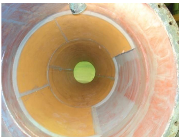
Футеровка внутренней поверхности гидроциклонов ГЦ-1400
