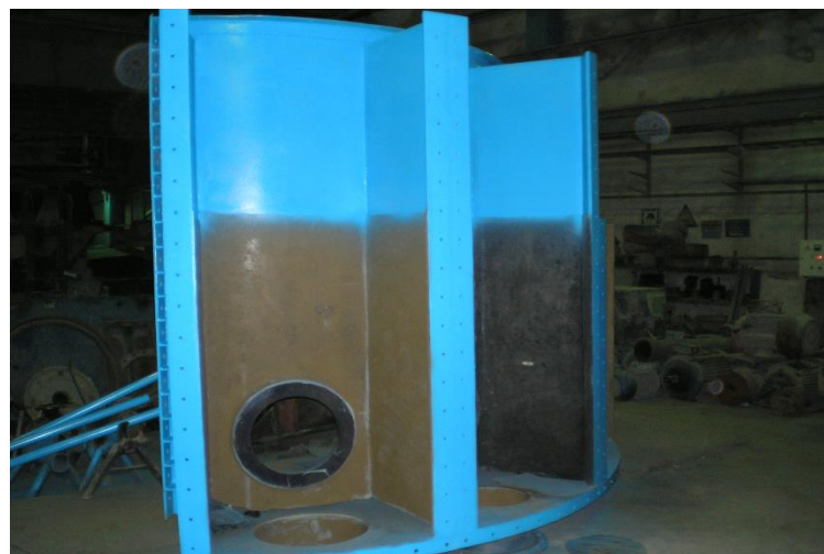
Седла и пробки выпускных отводов и боковых затворов выполнены из литьевого полиуретана.
