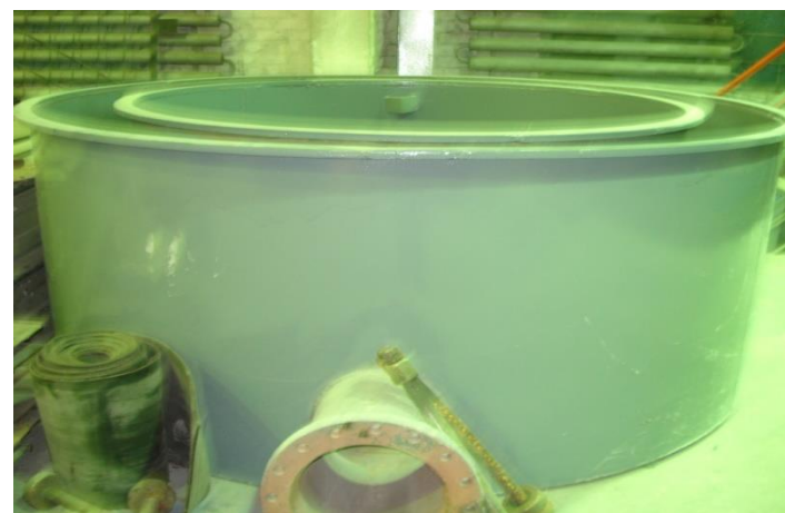
Футеровка песковой емкости гидроциклонов
