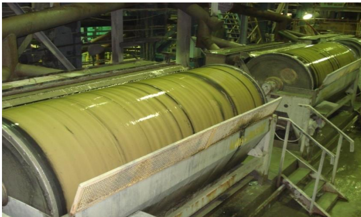
Гуммирование рабочих поверхностей барабанов ПБМ
